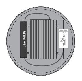
Telecontrollo totale tramite tecnologia onde convogliate. Tutti i nostri corpi illuminanti LED sono predisposti per ilbox POWER ONE con protocollo di comunicazione nativo DALI 1-10V. La CB è in grado di regolare il driver a cui è collegata in modalità 0-10V.
