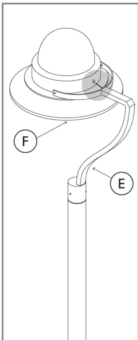
FASE 7: inserire i cavi in uscita da (E) nel foro di entrata di (F)
