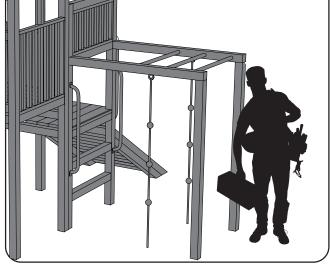
1. Ispezione visiva dello stato delle attrezzature, ponti sospesi, tiranti metallici, catene, parti oscillanti, funi, sartie, ecc.
